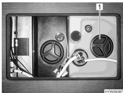
Bilde 220 Rengjøringsåpning (vanntank)
