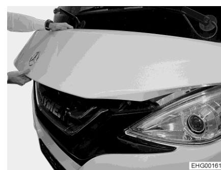
Bilde 39 Riktig håndtaksposisjon for åpning av motorlokket
