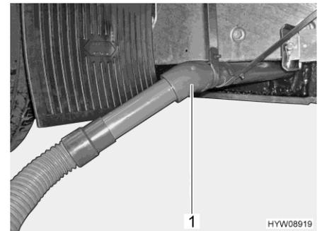
Fig. 208 Tubo de salida con manguera de aguas residuales
