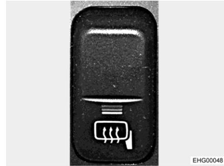
Fig. 34 Interruptor (calefacción de los retrovisores)
