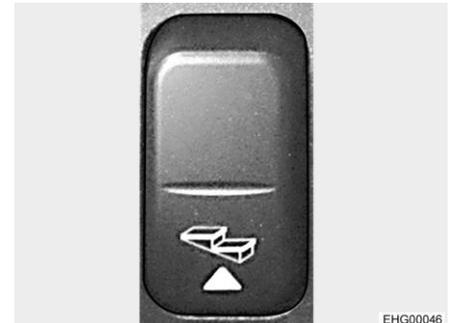
Fig. 10 Interruptor basculante para el escalón de entrada (panel de interruptores)
