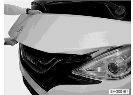
Fig. 39 Posición de agarre correcta para abrir el capó del motor
