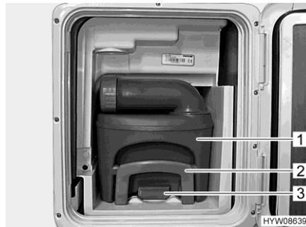
Fig. 215 Depósito de aguas fecales (en el vehículo)
