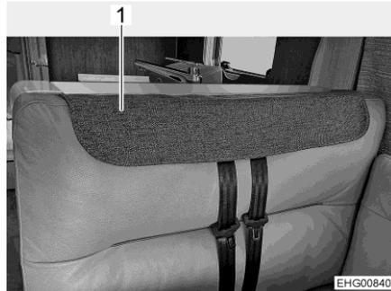
Fig. 16 Cubierta para cinturones de seguridad instalada
