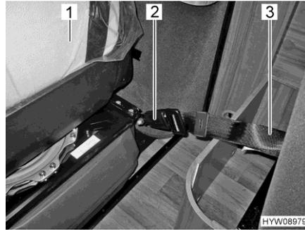
Fig. 27 Retener el asiento de enchufe con hebilla
