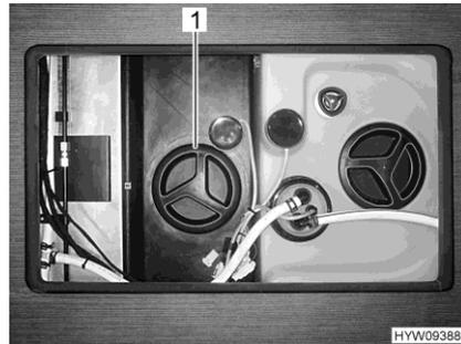
Fig. 221 Orificio de limpieza (depósito de aguas residuales)
