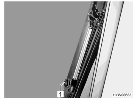
Fig. 67 Soporte rotatorio (ventana de techo abatible)
