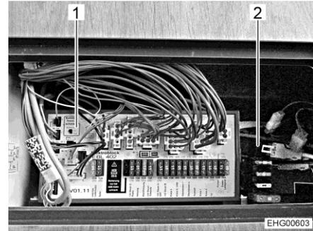
Fig. 154 Bloque eléctrico EBL 402 y portafusibles
