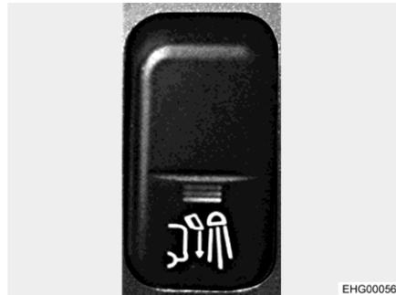
Fig. 45 Interruptor basculante (iluminación de la zona posterior)
