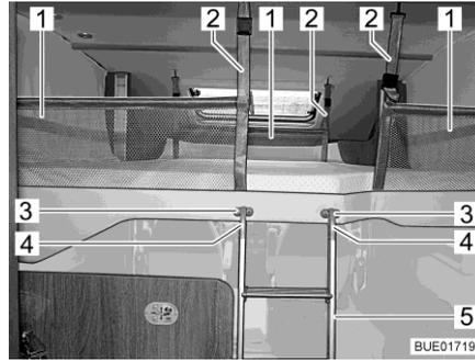
Fig. 106 Cama elevada con red de seguridad tendida
