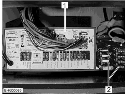
Fig. 153 Bloque eléctrico EBL 30 y portafusibles
