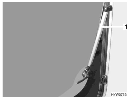
Fig. 64 Ventana abatible con soporte automático
