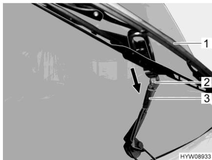
Fig. 226 Cambiar hoja de limpiaparabrisas
