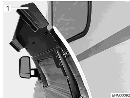
Fig. 132 Caja para bombonas de gas (trampilla exterior abierta)
