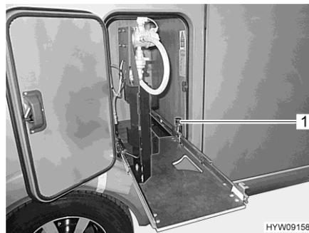
Fig. 131 Dispositivo de extracción de caja para bombonas de gas en posición de cambio
