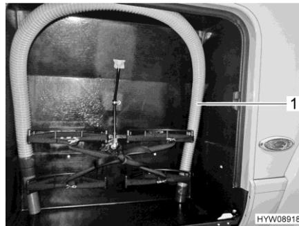
Fig. 207 Manguera de aguas residuales (caja para bombonas de gas)
