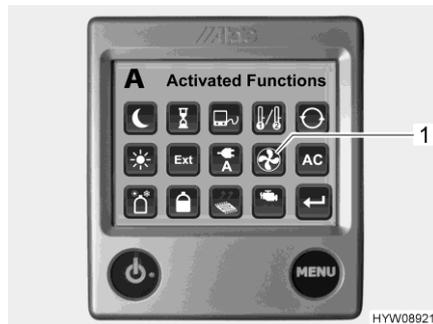
Fig. 178 Funciones activadas (ventilador adicional)
