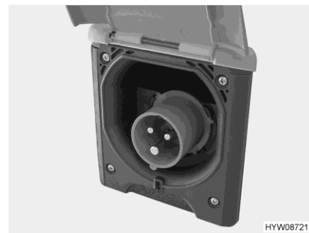
Bild 151 230-V-Anschluss am Fahrzeug (CEE-Steckdose)
