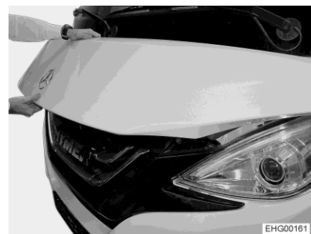
Bild 39 Korrekte Griffposition zum Öffnen der Motorhaube
