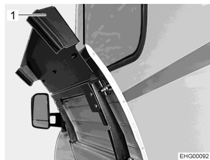
Bild 132 Gaskasten (Außenklappe geöffnet)
