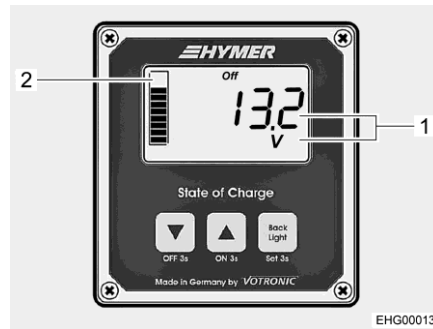
Bild 141 Anzeigepanel (Anzeige Batterie-Spannung)
