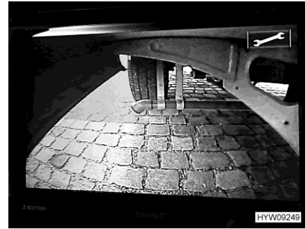
Bild 37 Anzeige der Abwassertankkamera (Beispiel)
