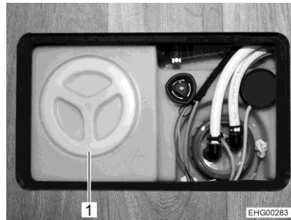
Fig. 116 Orificio de limpieza (depósito de agua)
