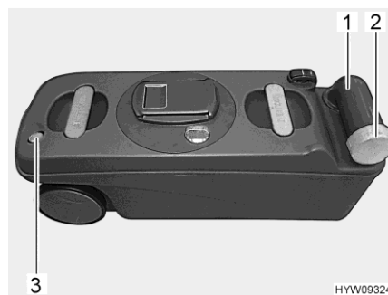
Fig. 165 Serbatoio fecale (esempio)
