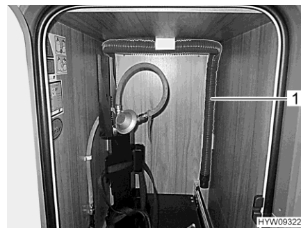
Kuva 154 Jätevesiletku (kaasupullokotelon alusta)
