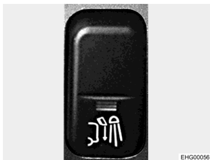
Kuva 23 Vipukytin (taka-alueen valaistus)
