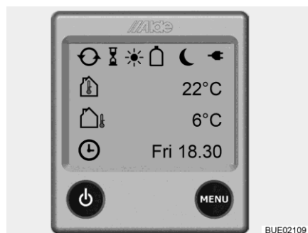
Fig. 118 Écran de démarrage (unité de commande)
