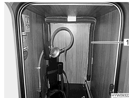
Bild 154 Avloppsslang (utdragsdel till gasbox)
