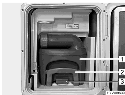
Bild 164 Latrintank (i fordonet)
