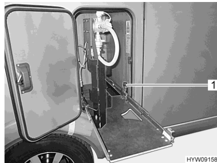
Afb. 82 Gaskast-uitschuifdeel in vervangingsstand
