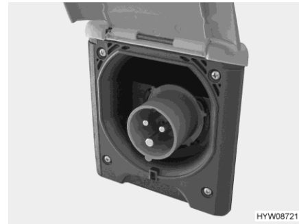
Afb. 98 230-V-aansluiting op het voertuig (CEE-contactdoos)
