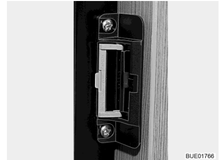
Fig. 146 Dispositivo de cierre (posición de ventilación)
