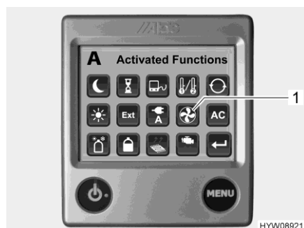
Fig. 124 Funciones activadas (ventilador adicional)
