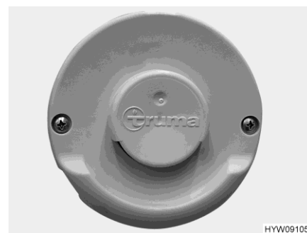
Fig. 127 Tubo de chimenea en la pared (calefacción de aire caliente)
