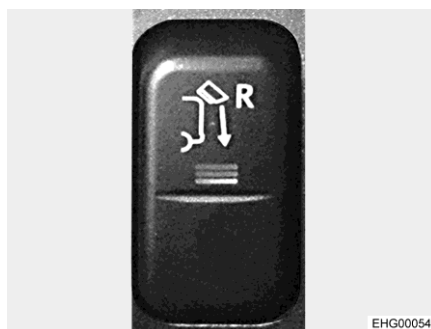
Fig. 20 Interruptor basculante (módulo de cámara/cámara del depósito de aguas residuales)
