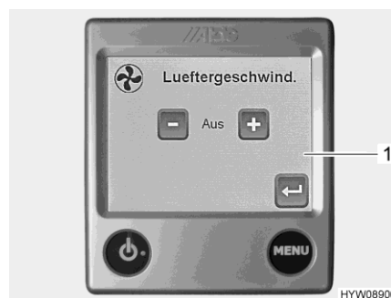
Fig. 125 Mando (ventilador adicional)
