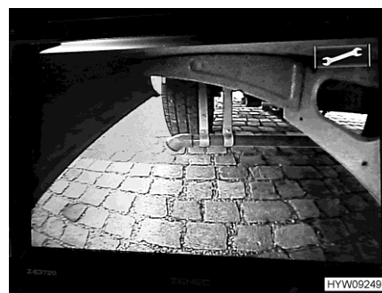
Fig. 21 Visualización de la cámara del depósito de aguas residuales (ejemplo)
