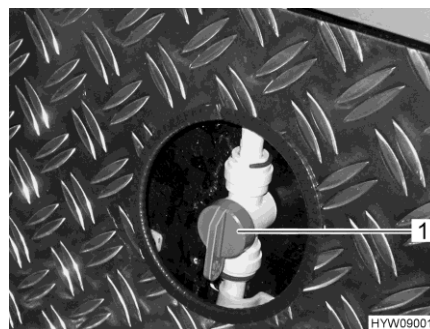
Fig. 129 Válvula de alimentación (calentamiento del garaje trasero)
