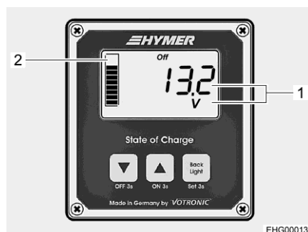
Fig. 128 Panel de visualización (visualización de la tensión de batería)
