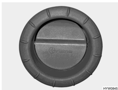
Fig. 149 Boquilla de salida de aire (calefacción de aire caliente)
