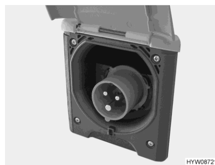
Fig. 135 Conexión de 230 V en el vehículo (caja de enchufe CEE)
