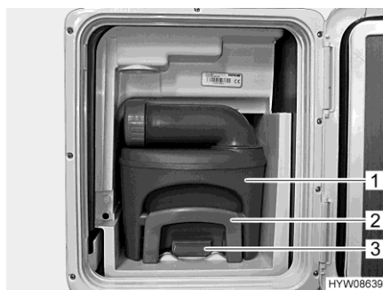
Fig. 203 Depósito de aguas fecales (en el vehículo)
