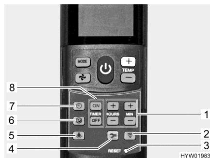
Fig. 175 Mando a distancia con teclas de ajuste (instalación de aire acondicionado)
