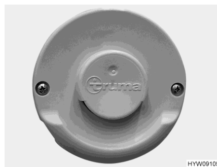
Fig. 172 Tubo de chimenea en la pared (calefacción de aire caliente)
