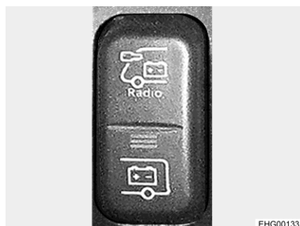
Fig. 124 Conmutador selector de alimentación de corriente de la radio
