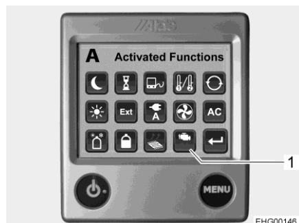
Fig. 167 Botón Calefacción del motor
