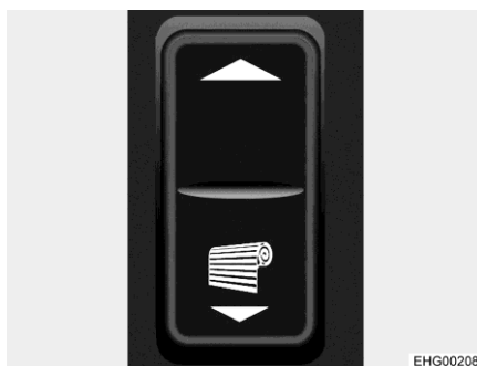
Fig. 66 Pulsador basculante (persiana oscurecedora enrollable/parasol)
