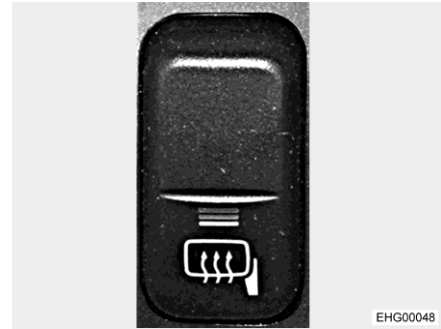
Fig. 31 Interruptor (calefacción de los retrovisores)
