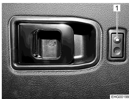
Fig. 29 Interruptor (elevalunas eléctrico en la puerta del conductor)
