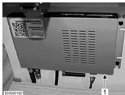
Fig. 143 Unidad de control (instalación de antena parabólica de TV)
