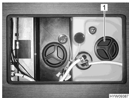
Fig. 208 Orificio de limpieza (depósito de agua)
