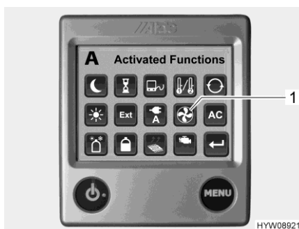
Fig. 165 Funciones activadas (ventilador adicional)
