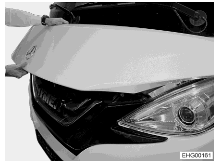
Fig. 34 Posición de agarre correcta para abrir el capó del motor
