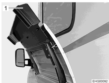
Fig. 117 Caja para bombonas de gas (trampilla exterior abierta)
