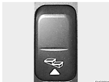
Fig. 6 Interruptor basculante para el escalón de entrada (panel de interruptores)
