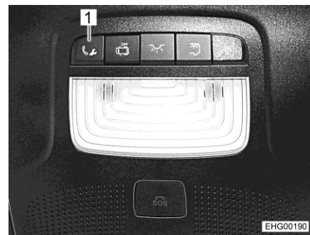
Fig. 9 Tecla para llamada en caso de avería (consola del techo)
