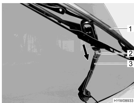
Fig. 214 Cambiar hoja de limpiaparabrisas
