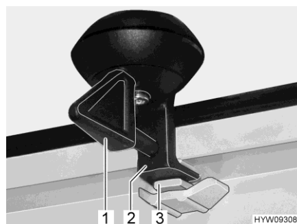
Fig. 72 Bloqueo (posición de ventilación)
