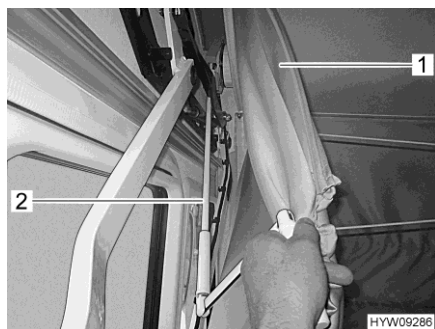
Fig. 68 Manivela para el funcionamiento de emergencia
