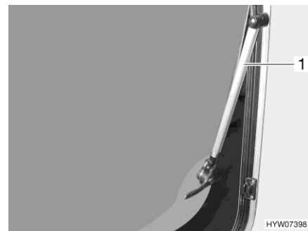
Fig. 58 Ventana abatible con soporte automático
