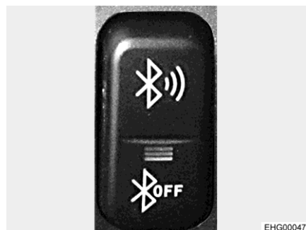
Fig. 125 Pulsador basculante (conexión Bluetooth)
