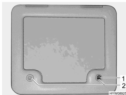
Fig. 202 Trampilla (depósito de aguas fecales)
