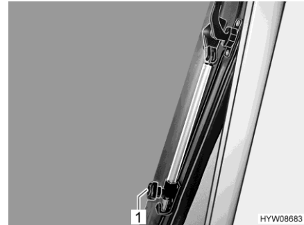
Fig. 61 Soporte rotatorio (ventana de techo abatible)
