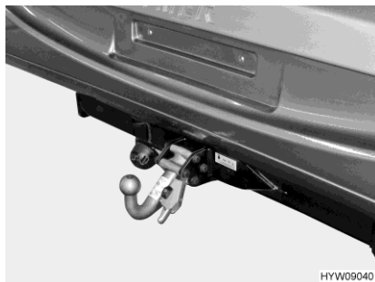
Fig. 4 Acoplamiento de remolque (desmontable)
