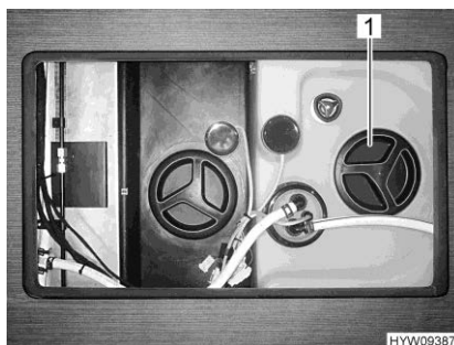
Bilde 208 Rengjøringsåpning (vanntank)
