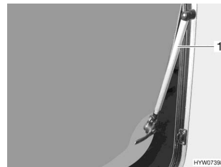
Bilde 58 Vindu som kan åpnes utover med armer med automatisk låsing
