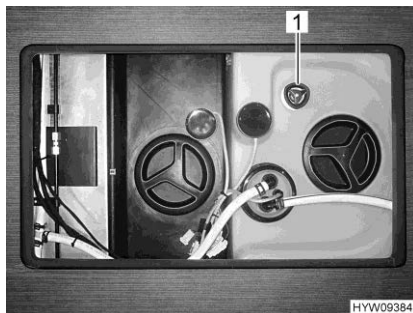
Bilde 193 Dreiehåndtak (vanntank)
