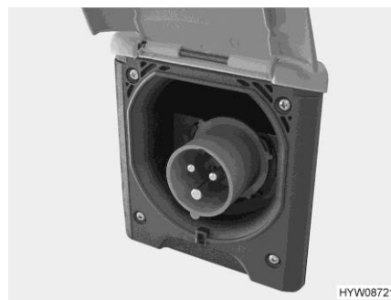
Bilde 135 230 V-tilkobling til kjøretøyet (CEE-stikkontakt)
