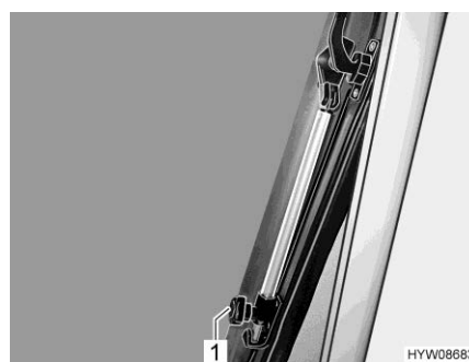
Bilde 61 Dreiearm (taklukevindu)
