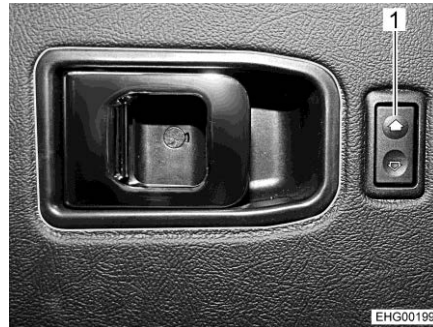
Bilde 29 Bryter (elektrisk vindusheis på i førerdøren)
