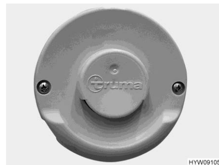
Bilde 172 Veggpipe (varmlufts-varmeanlegg)
