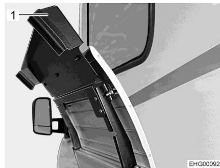
Bilde 117 Gasskap (uvendig luke åpent)
