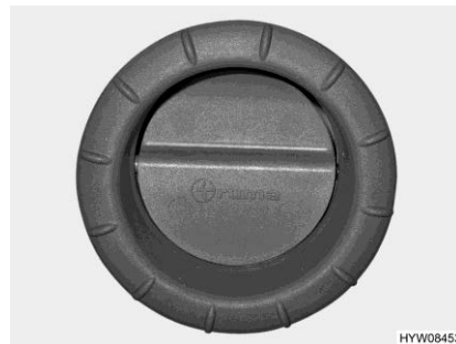
Bilde 149 Luftdyse (varmlufts-varmeanlegget)
