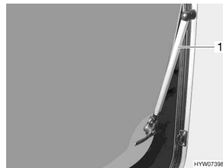
Fig. 58 Finestra apribile con deflettore automatico
