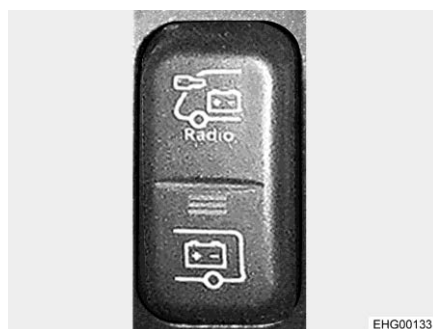
Fig. 124 Selettore per l'alimentazione elettrica della radio
