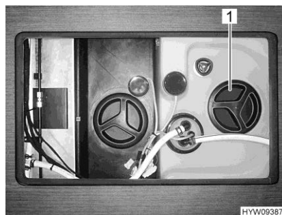
Fig. 208 Apertura per la pulizia (serbatoio dell'acqua)
