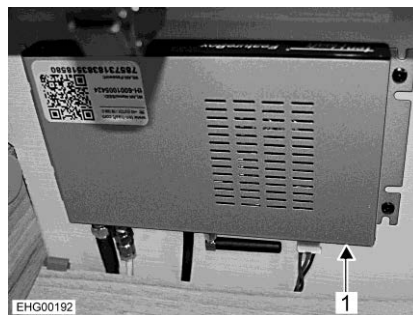
Fig. 143 Apparecchio di controllo (impianto satellitare TV)
