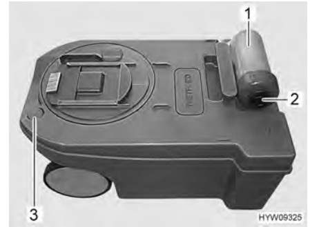
Fig. 115 Depósito de aguas fecales (alternativa)
