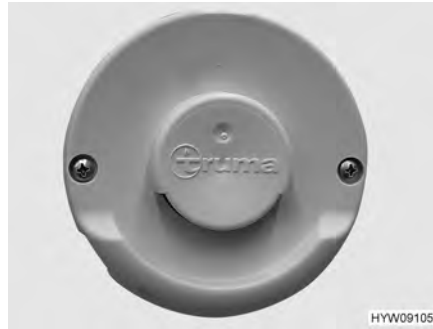
Fig. 79 Tubo de chimenea en la pared (calefacción de aire caliente)
