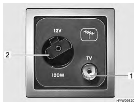
Fig. 49 Cajas de enchufe (antena parabólica externa)
