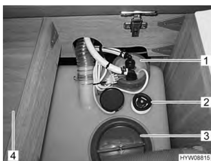
Fig. 95 Depósito de agua
