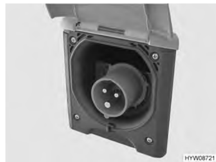
Fig. 67 Conexión de 230 V en el vehículo (caja de enchufe CEE)
