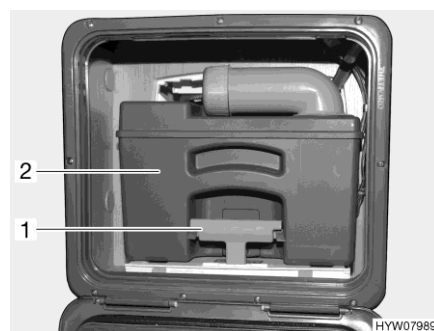
Fig. 112 Depósito de aguas fecales (en el vehículo)
