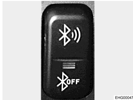
Fig. 70 Pulsador basculante (conexión Bluetooth)
