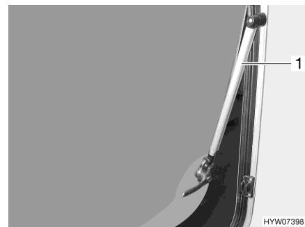
Bild 64 Överkantshängt fönster med automatik-spärr
