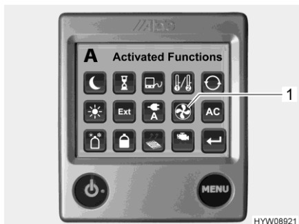
Bild 178 Aktiverade funktioner (extra fläkt)
