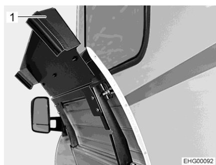
Bild 132 Gasbox (utvändig lucka öppen)
