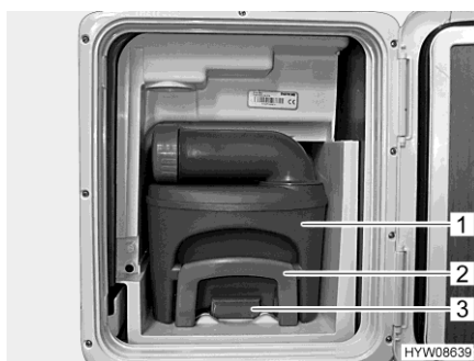
Bild 215 Latrintank (i fordonet)
