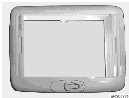
Obr. 77 Střešní poklop (zavřený)
