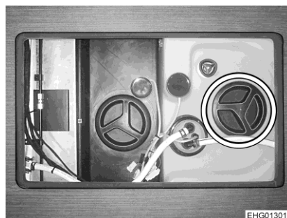
Obr. 219 Čisticí otvor (nádrž na vodu)
