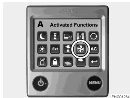
Obr. 178 Funkce Booster (přídavný ventilátor)
