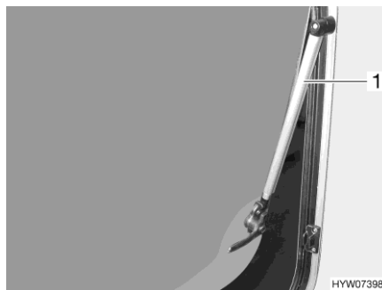
Obr. 62 Vyklápěcí okno s automatickým vyklápěcím mechanismem
