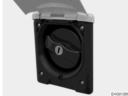
Rys. 144 Korek zamykający (króciec do napełniania wody pitnej)
