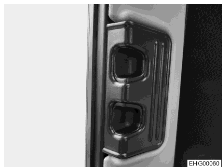
Rys. 48 Uchwyt blokujący (okno pasażera)
