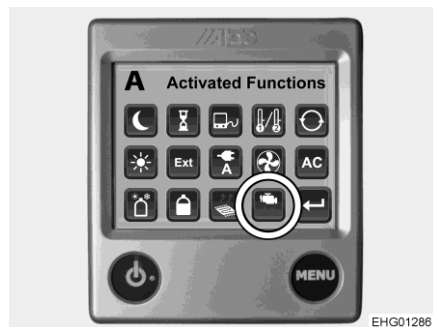
Rys. 125 Funkcja podgrzewania silnika (dodatkowa dmuchawa)
