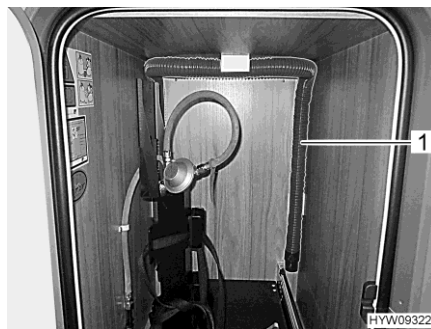
Rys. 147 Wąż odprowadzający ścieki (wyciągana skrzynia na butle gazowe)
