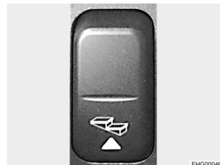
Rys. 11 Przelącznik kołyskowy do stopnia do wchodzenia (listwa z przelącznikami)
