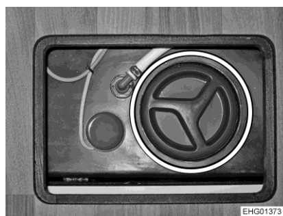
Rys. 162 Otwór do czyszczenia (zbiornik na ścieki)
