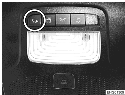
Rys. 14 Przycisk wzywania pomocy drogowej (konsola dachowa)
