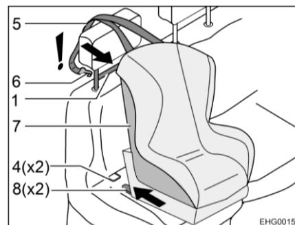
Rys. 21 Mocowanie za pomocą Isofix
