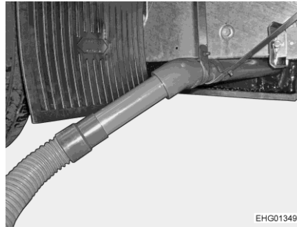
Rys. 148 Rura odpływowa z węzłem odprowadzającym ścieki
