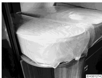
Rys. 81 Przedłużenie powierzchni do leżenia z użyciem dodatkowej poduszki
