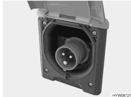
Rys. 107 Przyłącze 230 V w pojeździe (gniazdo CEE)
