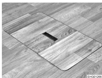
Rys. 61 Osłona serwisowa (zagłębiony uchwyt)
