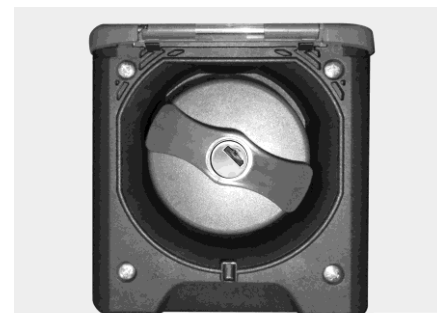
Bild 125 Locket påfyllningsöppningen för dricksvatten
