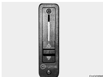
Bild 115 Skjutreglage för varmlufts-spridning i sovtaket
