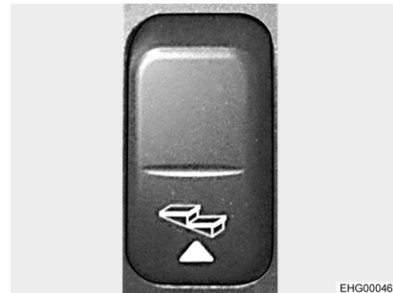
Fig. 6 Commutateur à bascule pour le marchepied (barrette de commutateurs)
