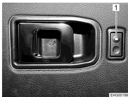
Fig. 29 Commutateur (lève-vitre électrique dans la porte chauffeur)
