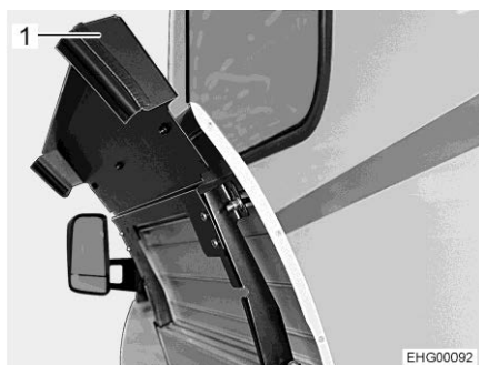
Fig. 117 Compartiment à gaz (portillon extérieur ouvert)
