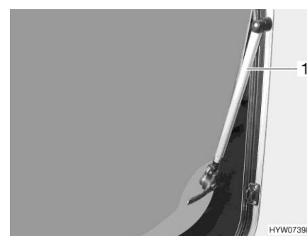
Fig. 58 Fenêtre projetante avec bras automatique
