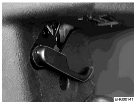
Fig. 33 Levier de déverrouillage du capot moteur
